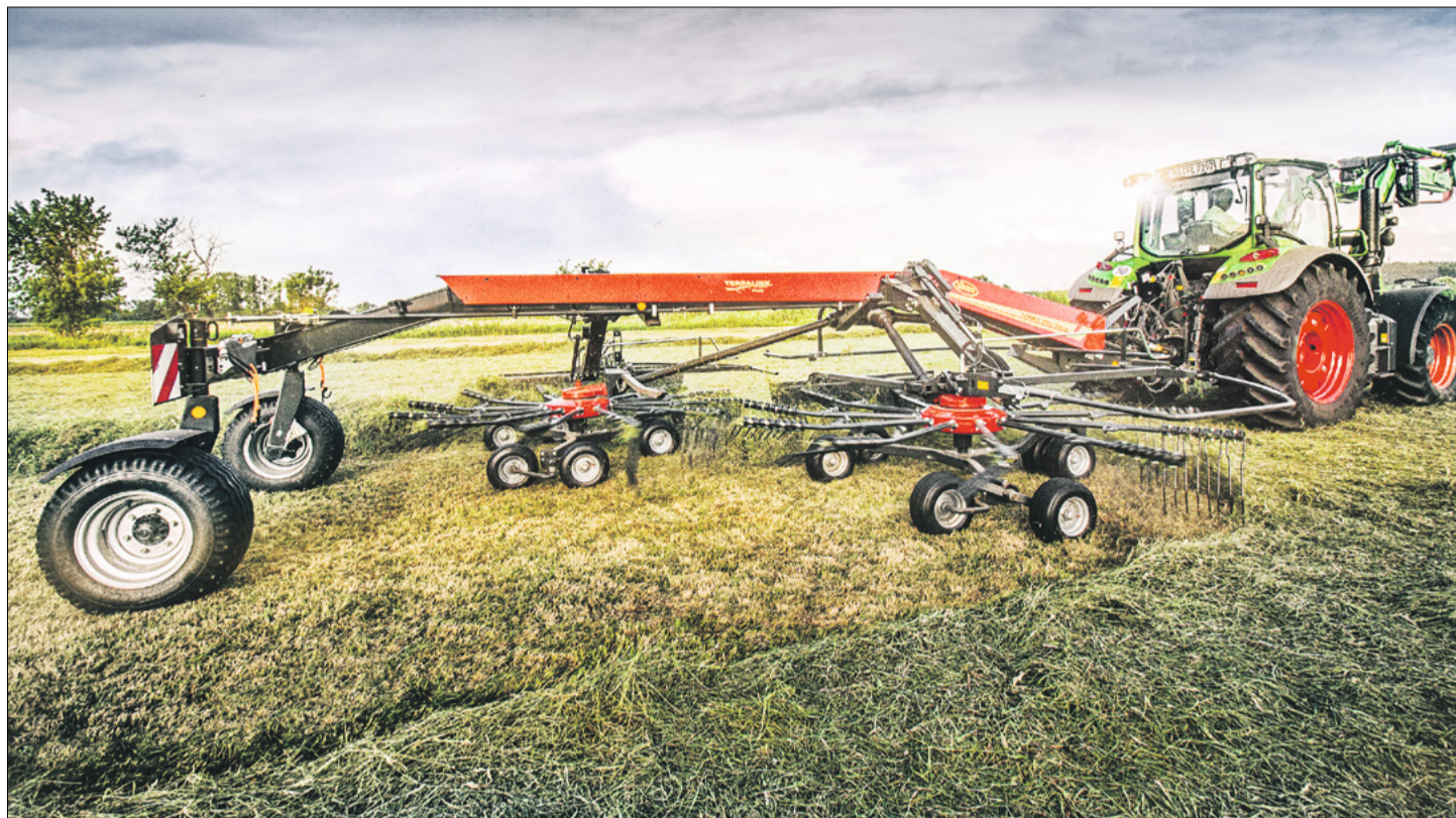
Das eigene Fahrwerk entlastet den Dreipunkt des Traktors. Die Belastung der Hinterachse und der Reifen wird reduziert. Zudem können auf einer eigenen Achse grössere und robustere Maschinen konstruiert werden. (Bild zVg)
