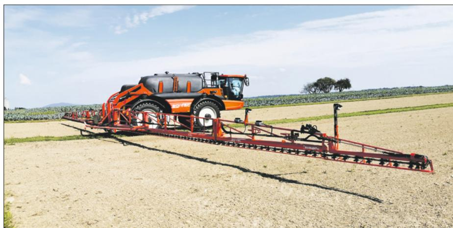
Agrifac hat eine Spritztechnologie entwickelt, welche die Spritzmittel bedarfsgerecht verteilt. Die Dosierung wird kameragesteuert für jede Düse einzeln geregelt. Das spart Mittel ein. *(Bild zvg)*
